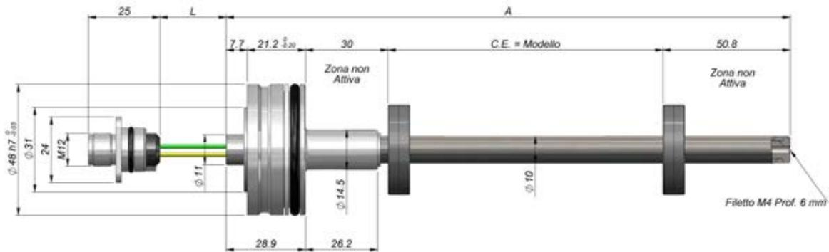
**ALLOGGIAMENTO SENSORE (particolare testa)**
